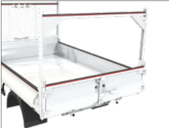
Abnehmbarer heckseitiger Bretterträger aus Stahl
