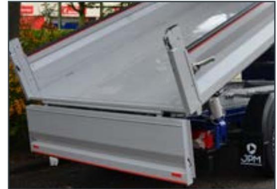
= Klappe mit automatischer Entriegelung + Klappe mit manueller Öffnung nach unten
