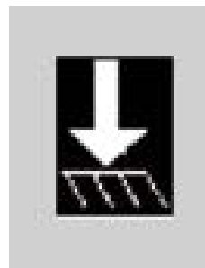
Tasto DOWN: discesa del ribaltabile trilaterale
