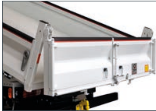
= Deur met automatische afkoppeling
