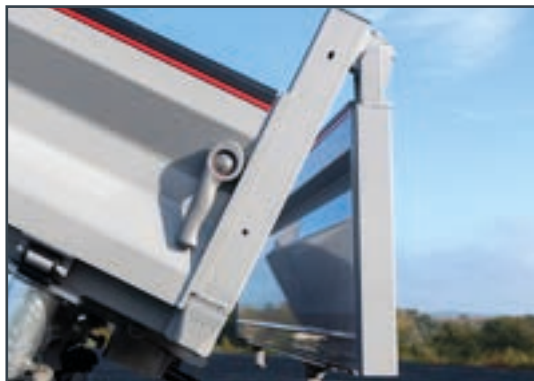
= Deur met automatische afkoppeling
