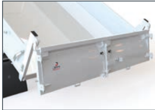
= Deur met automatische afkoppeling
